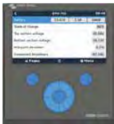
Color Control Caché derrière les boutons et l'écran couleur, le puissant ordinateur Linux rassemble les données provenant de tout équipement Victron et il les affiche à l'écran. En plus de communiquer avec l'équipement Victron, le Color Control communique à travers NMEA2000, Ethernet et USB.
