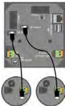
Au maximum, quatre BMV peuvent être connectés directement au Color Control. Davantage de BMV peuvent être connectés à un Hub USB pour un contrôle central.
