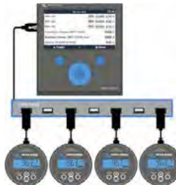
Au maximum, quatre BMV peuvent être connectés directement au Color Control. Davantage de BMV peuvent être connectés à un Hub USB pour un contrôle central.
