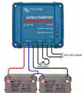
Battery Balancer (BMS012201000) Le Battery Balancer égalise l'état de charge de deux batteries de 12 V raccordées en série, ou de plusieurs files de batteries connectées en série, ces files étant elles-mêmes raccordées en parallèles.
